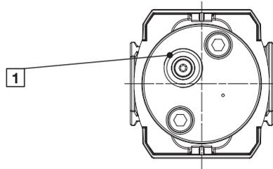
1 1/4" Entlüftungsanschluss (NPT oder ISO G)
